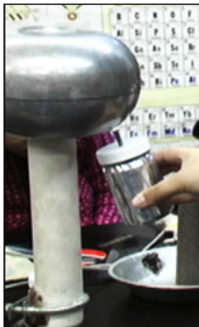
Charging the leyden jar with the Van de Graaf generator.
